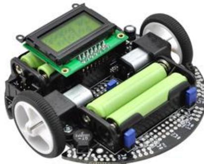
Le Pololu 3pi n'a pas un capteur de distance. Cependant, il est assez facile à souder un sur le devant. L'avantage du 3pi est qu'il tourne sur place, alors il est meilleur pour les virages serrés.
